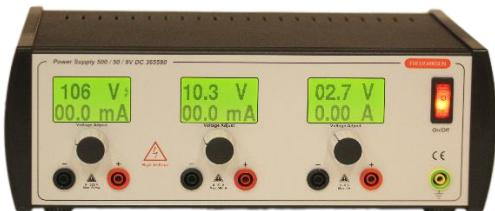
Denne DC-strømforsyning leverer et output på hele tre forskellige stabiliserede DC-spændinger. Alle udgange er tilsluttet et display, hvor der kan aflæses både spænding og strøm.
