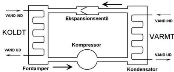
Kompressoren tvinger en passende væske fra fordamperen til kondensatoren, et område med højere tryk og temperatur ( $T_v$ ). Væsken tvinges videre gennem en ekspansionsventil. Trykket og temperaturen falder, og fordamperen er et område ved lavere temperatur ( $T_k$ ). De to i figuren viste varmeveksler muliggør, at varmeenergi fra omgivelserne overføres til og fra varmepumpen.
