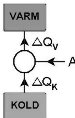
Man kan også betragte ligningen som en effektligning, idet A så forstås, som den ydede effekt (energi per sekund). I dette ideelle tilfælde, idet vi ser bort fra energitab, mm., vil man få overført  $\Delta Q_v$  til et område, hvor der er et varmebehov, mens man kun skal yde (betale for) energien A. I praksis vil man for eksempel hente varmen fra udendørsluften, fra et stort vandreservoir eller lignende energilager med stort set ubegrænset lavtemperatur varmeenergi til rådighed.
